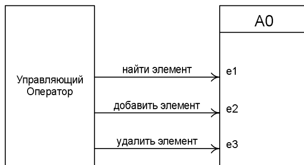
Рис. 24. Схема связей главного автомата
