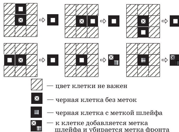
■ Рис. 3. Правила клеточного автомата с метками, осуществляющего распространение волны по точкам изображения символа
