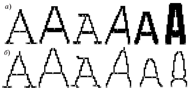
■ Рис. 7. Выделение признаков с помощью клеточных автоматов с метками на примере буквы «А» в различных стилях без предварительного уточнения изображения (а) и с уточнением изображения (б)
