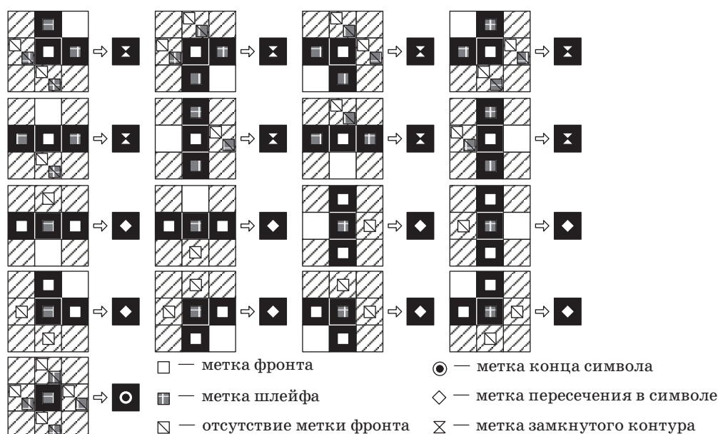
■ Рис. 4. Правила клеточного автомата с метками, выделяющего места угасания, встречи и разделения волн
