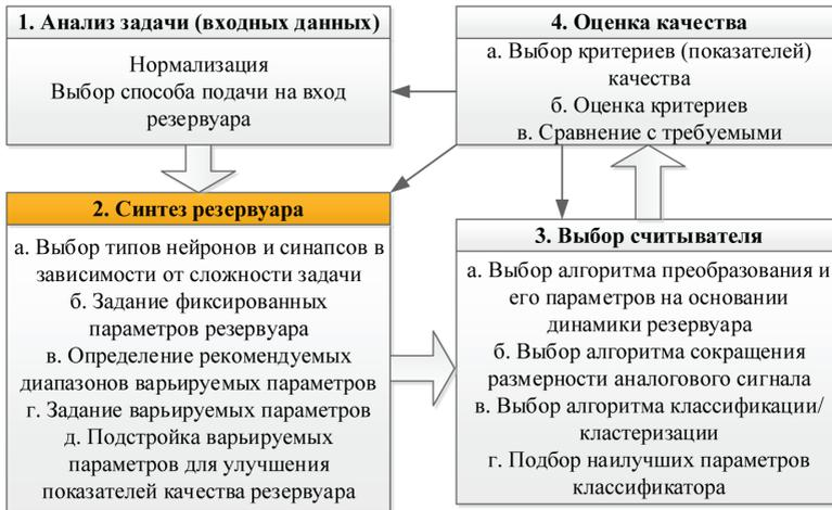
**Рис. 2.** Методика синтеза импульсных РНС при решении задачи распознавания динамических образов с помощью МНС
