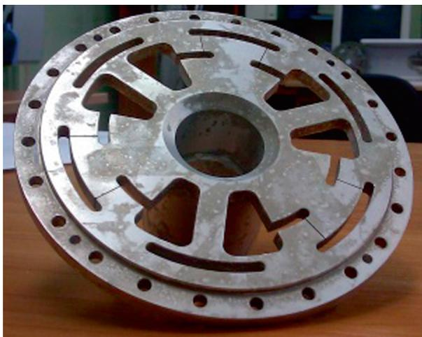
Рис. 1. Фланец однокомпонентного датчика момента
