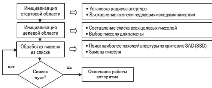
Рис. 2. Схема работы алгоритма восстановления
