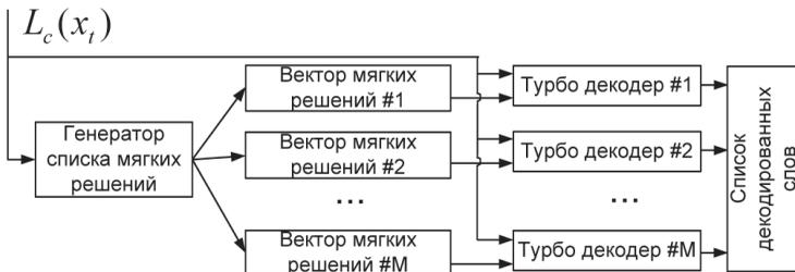
Рис. 3. Схема списочного декодера турбо кода
