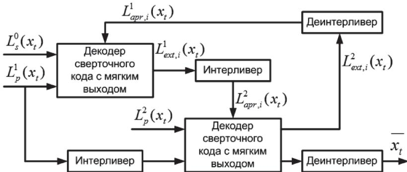
Рис. 2. Схема декодера турбо кода
