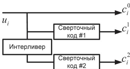
**Рис. 1.** Схема кодера турбо кода
