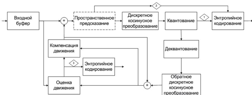
Рис. 1. Типовая схема кодера H.264
