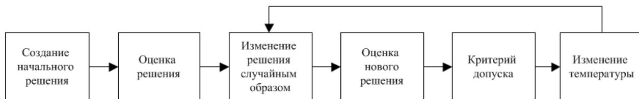
Рис. 1. Схема алгоритма отжига
