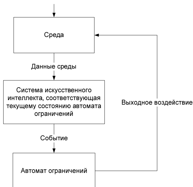
Рис. 4. Основной цикл работы системы под управлением автомата ограничений
