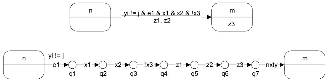
Рис. 5. Выделение промежуточных состояний для автоматного перехода
