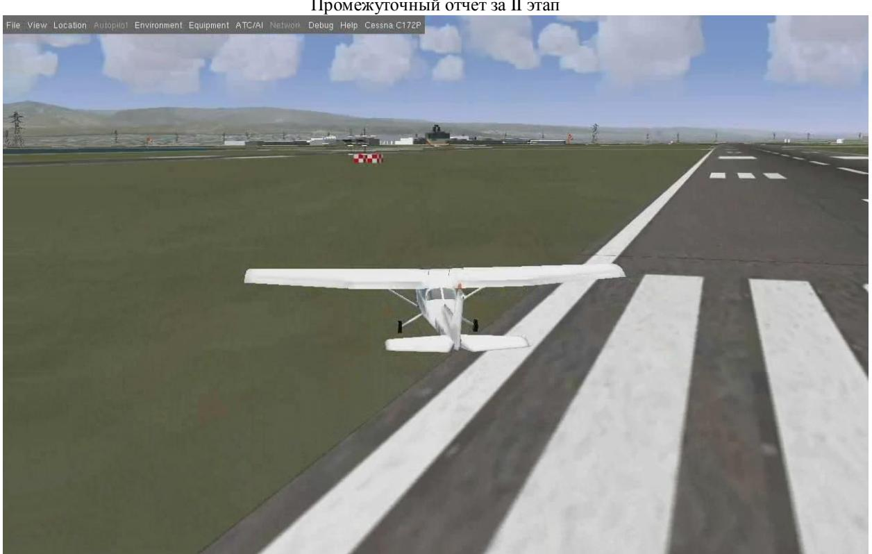
Рис. 23. Поведение автомата, который «держит штурвал прямо» (14-я секунда разгона)
