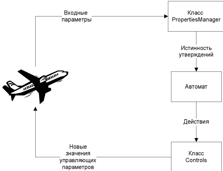
Рис. 12. Управление моделью беспилотного самолета с помощью автомата
