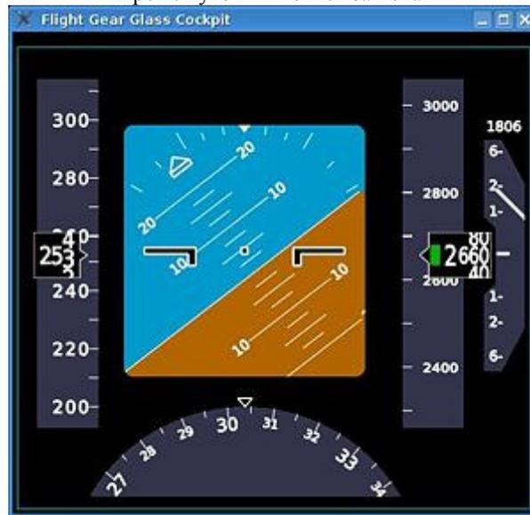
Рис. 43. Приборная панель симулятора *FlightGear*
