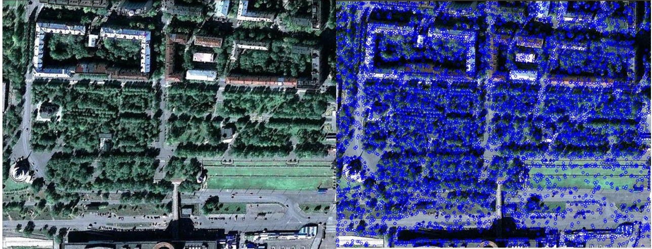
Рис.1 — Слева — пример фотографии, полученной при АФС, справа — результат работы на данной фотографии детектора SIFT
