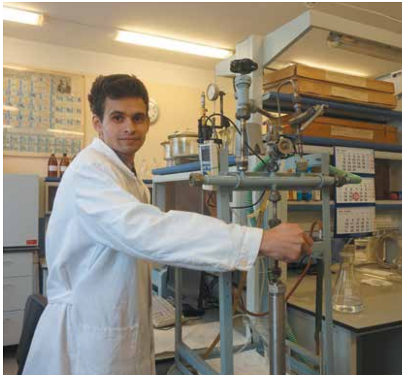
Химическая лаборатория занимается вопросами поддержания водно-химического режима судовых энергоустановок. Сотрудники лаборатории самостоятельно создали установку для получения обессоленной воды, которая используется в работе
