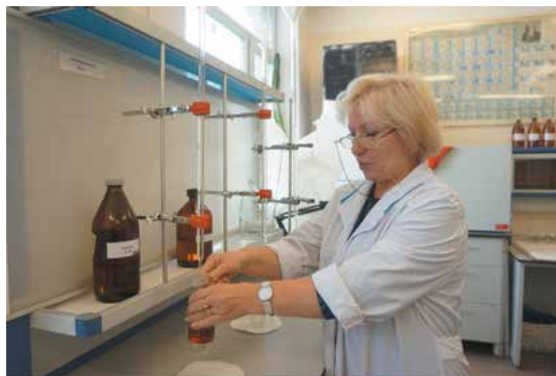
Химическая лаборатория. Ведущий инженер Т.Ф. Лебедева определяет содержание продуктов коррозии в воде
