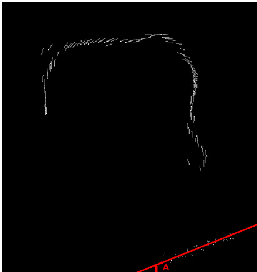
Рис. 11. Угол отклонения расчетного положения стены от реального
