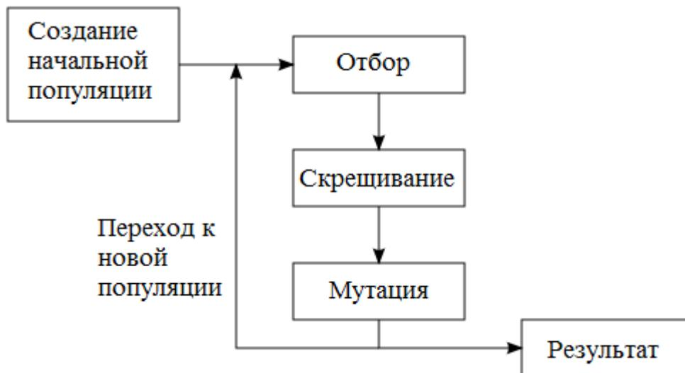
Рис. 3 — Схема генетического алгоритма
