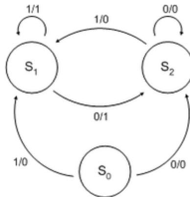
Рис. 2 — Графическое изображение автомата Мили
