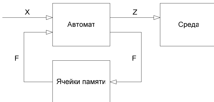
Рис. 23. Структурная схема для автомата с флагами
