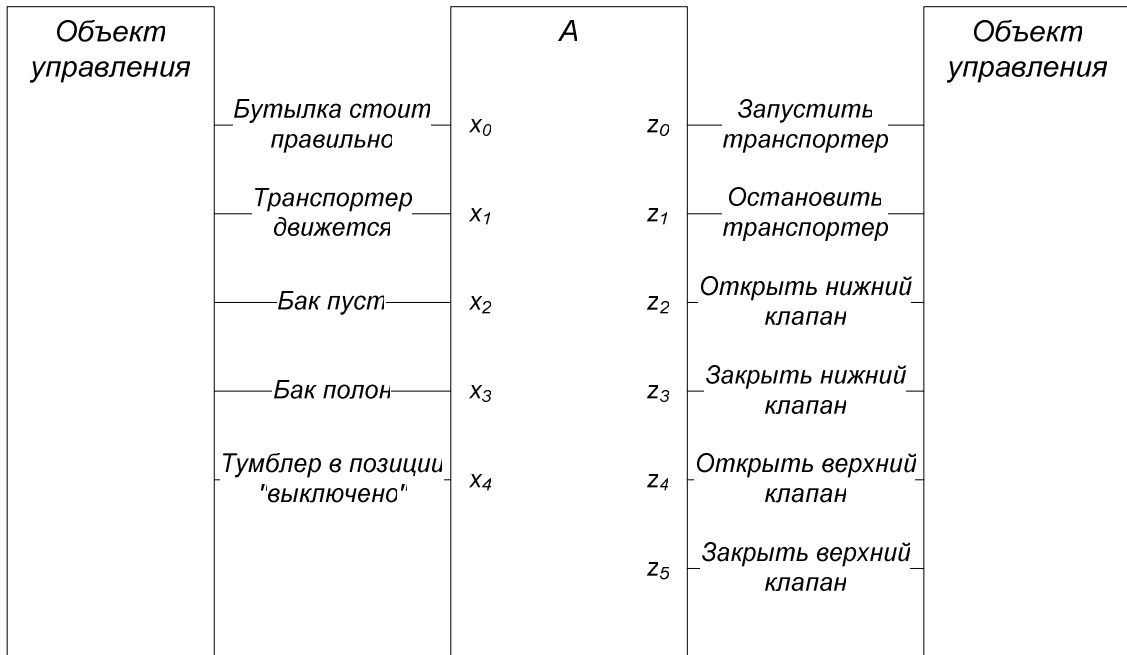
Рис. 57. Схема связей управляющего автомата разливочной линии
