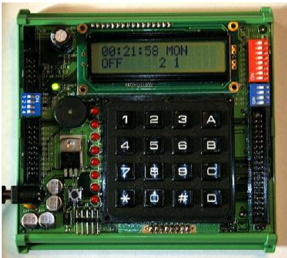
Рис. 11. Стенд SDK1.1 с загруженной управляющей программой. Обычный режим
