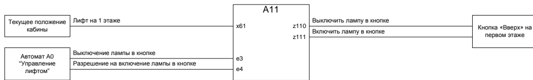
Рис. 8. Схема связей автомата “Кнопка «Вверх» на первом этаже”
