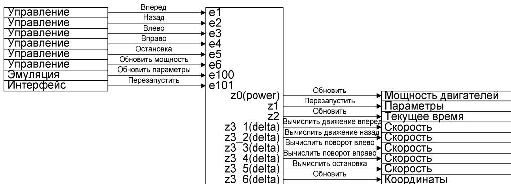
Рис. 79. Схема связей автомата SixWheeledTransport
