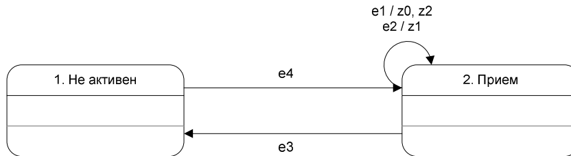
Рис. 72. Граф переходов автомата InfraredReceiver
