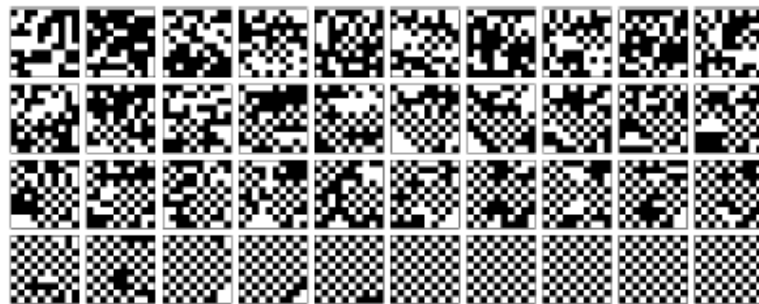
Рис. 7. Изображение показывает корректную работу двумерного клеточного автомата при решении проблемы шахматной доски. Работа начинается с верхнего левого угла со случайного начального состояния для поля 10 на 10 клеточного автомата, проходит слева направо, сверху вниз и заканчивается идеальным шахматным шаблоном в конечном состоянии
