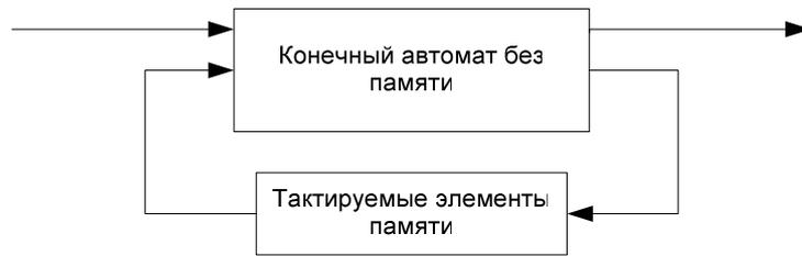
Рис. 9. Синхронный автомат с памятью
