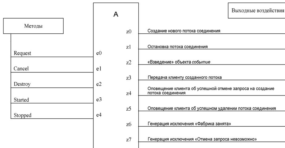
Рис. 45. Схема связей автомата **ThreadFactory**
