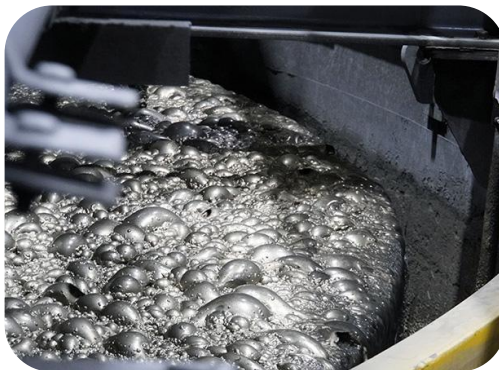
Анализ размера, формы, цветности, скорости пузырьков флотации для корректировки рецептов
