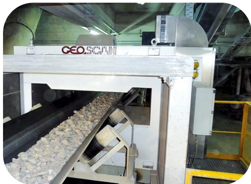
Гранулометрия (анализ размера и поиск негабарита) руды для корректировки режима мельницы
