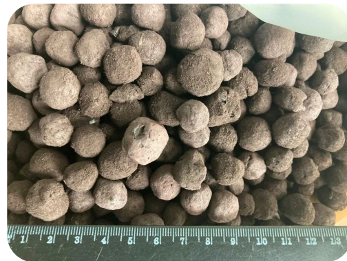
Анализ размера и влажности окатышей руды для корректировки рецептов
