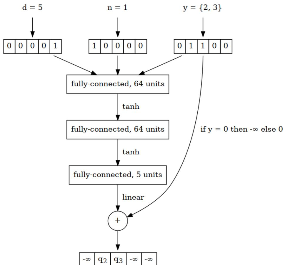
Рисунок 5 – Feed-forward архитектура сети для графа из 5 узлов
