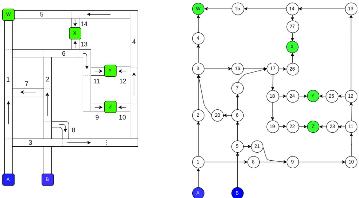
Рисунок 15 – Модель конвейерной системы для тестов
