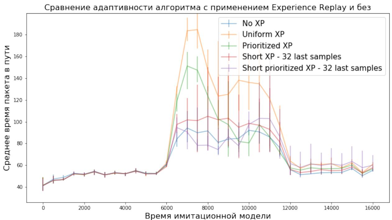
Рисунок Б.9 – Сравнение эффективности версий алгоритма с использованием различных модификаций experience replay
