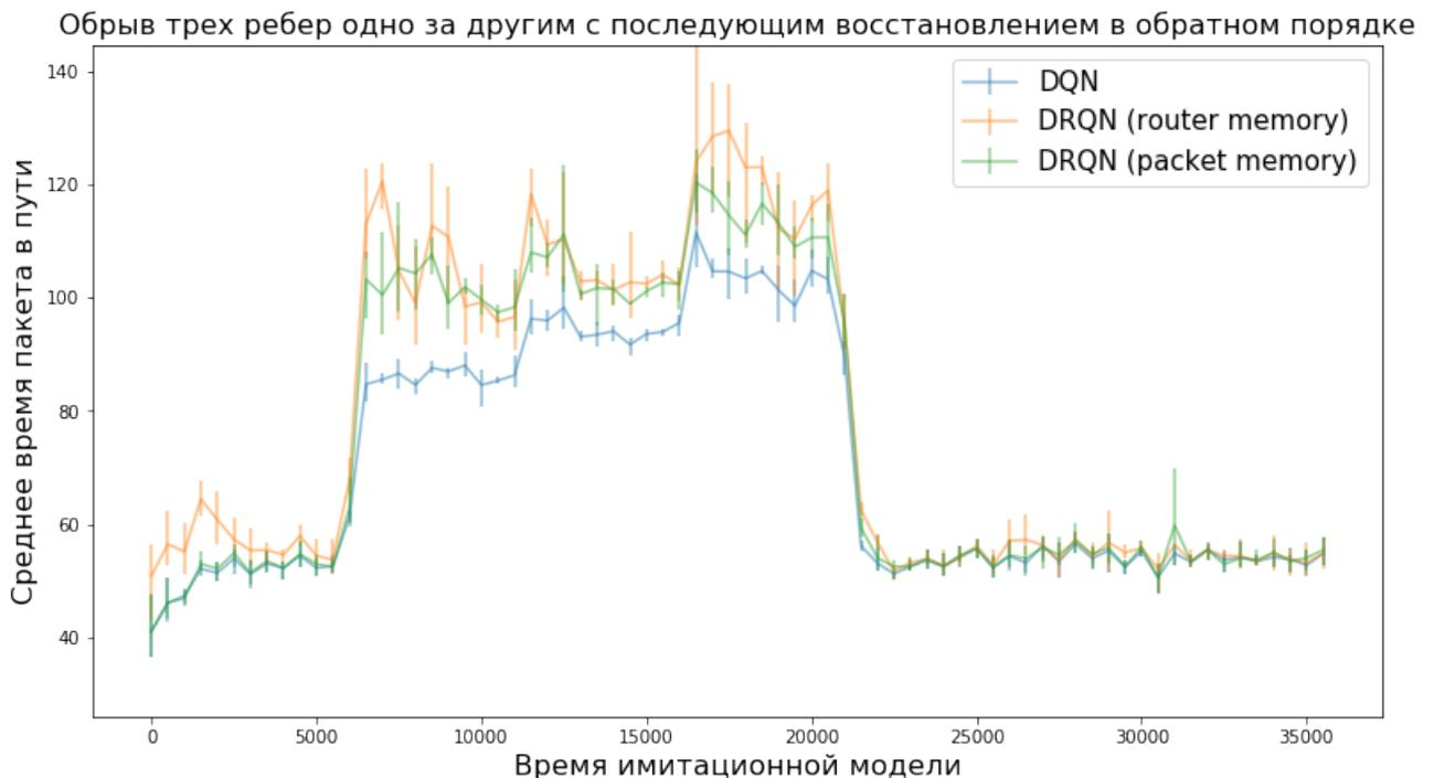
Рисунок 11 – Изменение топологии сети (сравнение нейросетевых архитектур)
