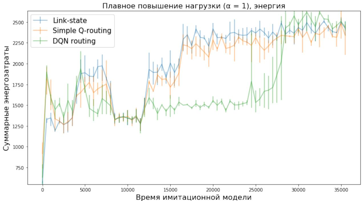
Рисунок 21 – Энергозатраты в условиях плавного повышения нагрузки,  $\alpha = 1$
