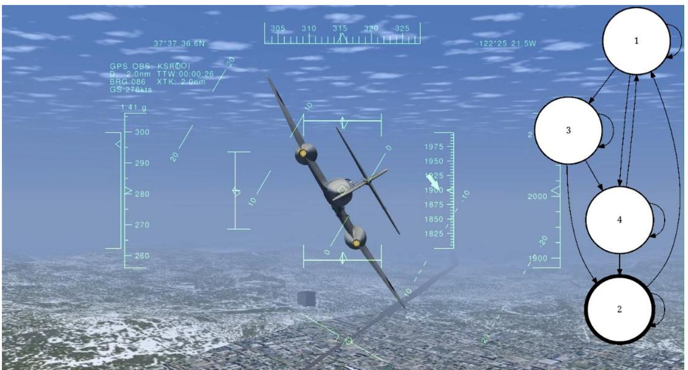
**Рис. 13.** Выполнение разворота истребителем *Gloster Meteor* под управлением одного из построенных автоматов с предложенным способом представления (снимок экрана)
