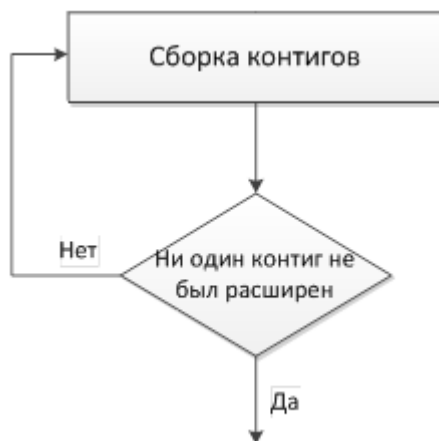
Рис. 2. Высокоуровневая блок-схема алгоритма сборки контигов
