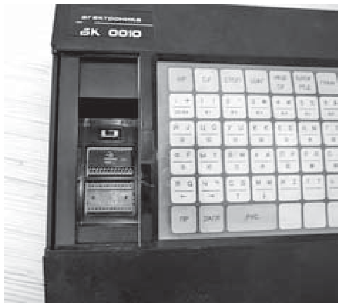
БК-0010: панельки и переключатель сброса
