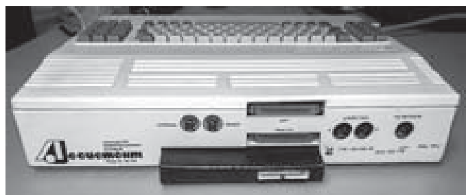
«Ассистент-128»: разъемы: вставлен контроллер дисководов (вид сзади)
