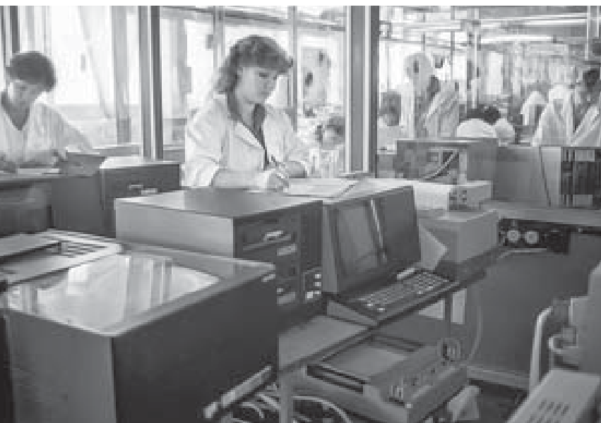
Завод «Счетмаш», технолог проводит контрольную проверку ПКВМ «Искра-226». 1984 г.
