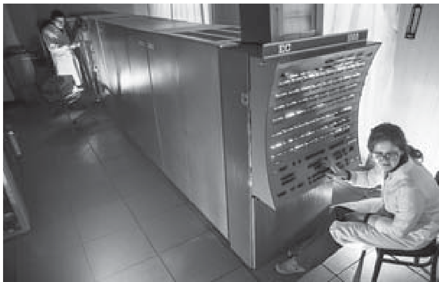
В Вычислительном центре АН СССР, 1983 год. Инженеры проводят тестовую проверку памяти ЭВМ ЕС-1060
