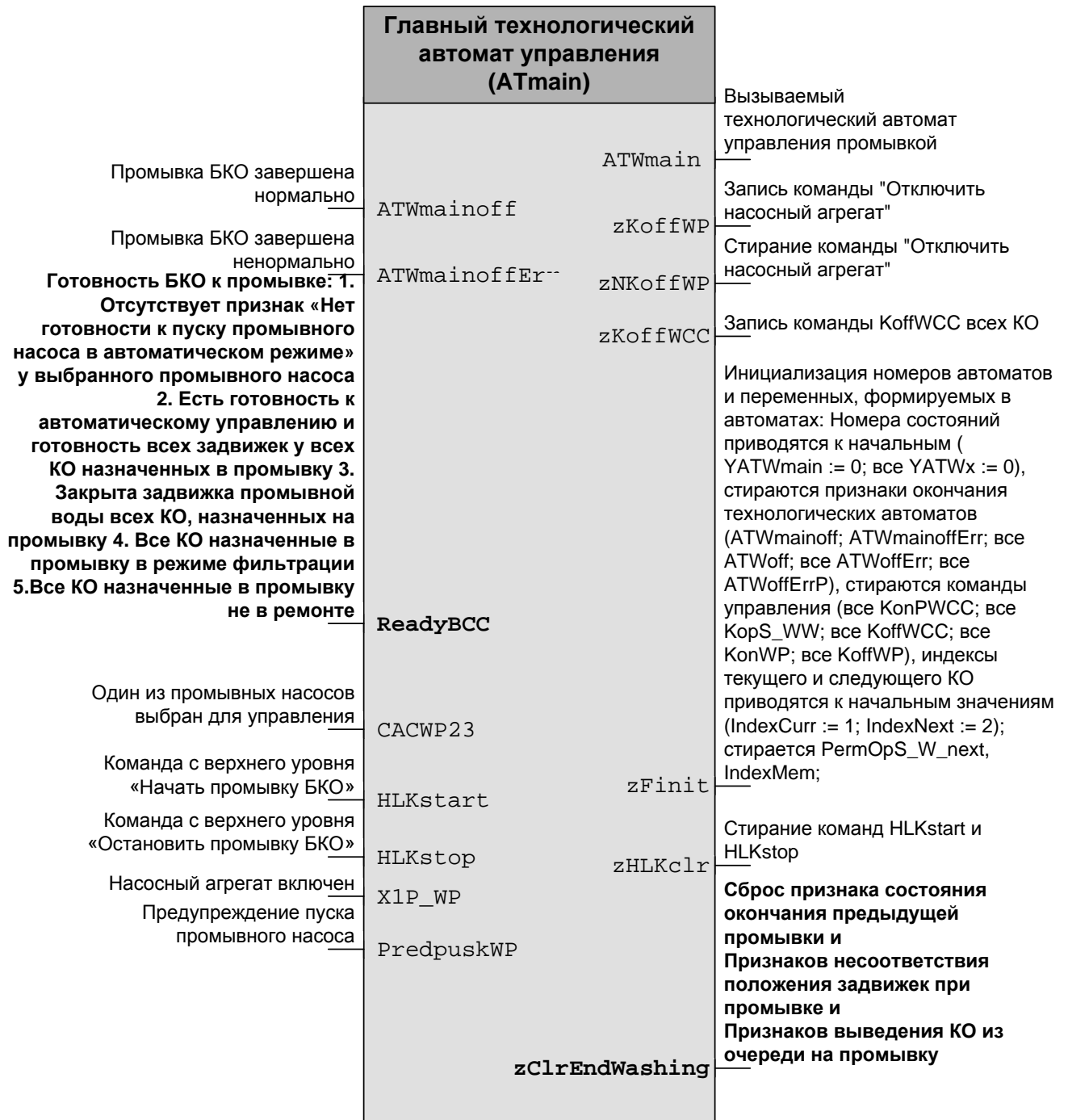
Рис. 17. Схема связей главного технологического автомата управления (ATmain)
