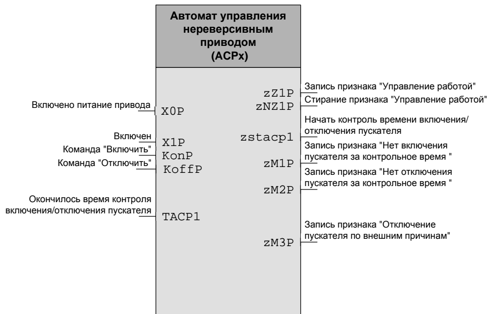
Рис. 3. Схема связей автомата управления нереверсивным приводом
