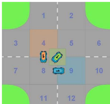
Рис. 3. Разбиение перекрестка на зоны. Машина на середине перекрестка находится в зоне 13 и пропускает машину, движущуюся вниз
