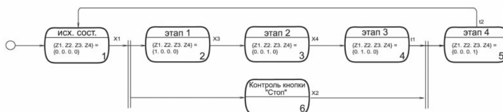
Рисунок 4 Граф переходов системы управления с параллельными потоками
