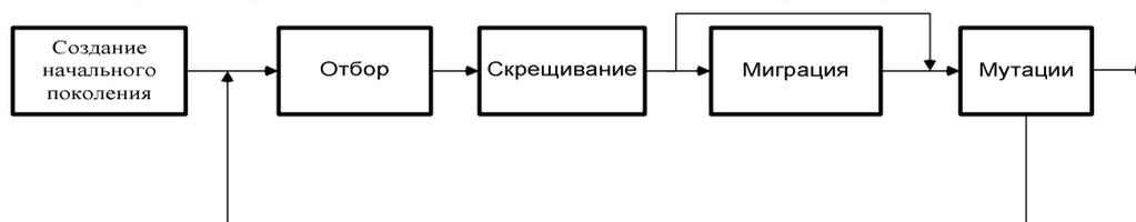
Рис. 7. Схема островного генетического алгоритма
