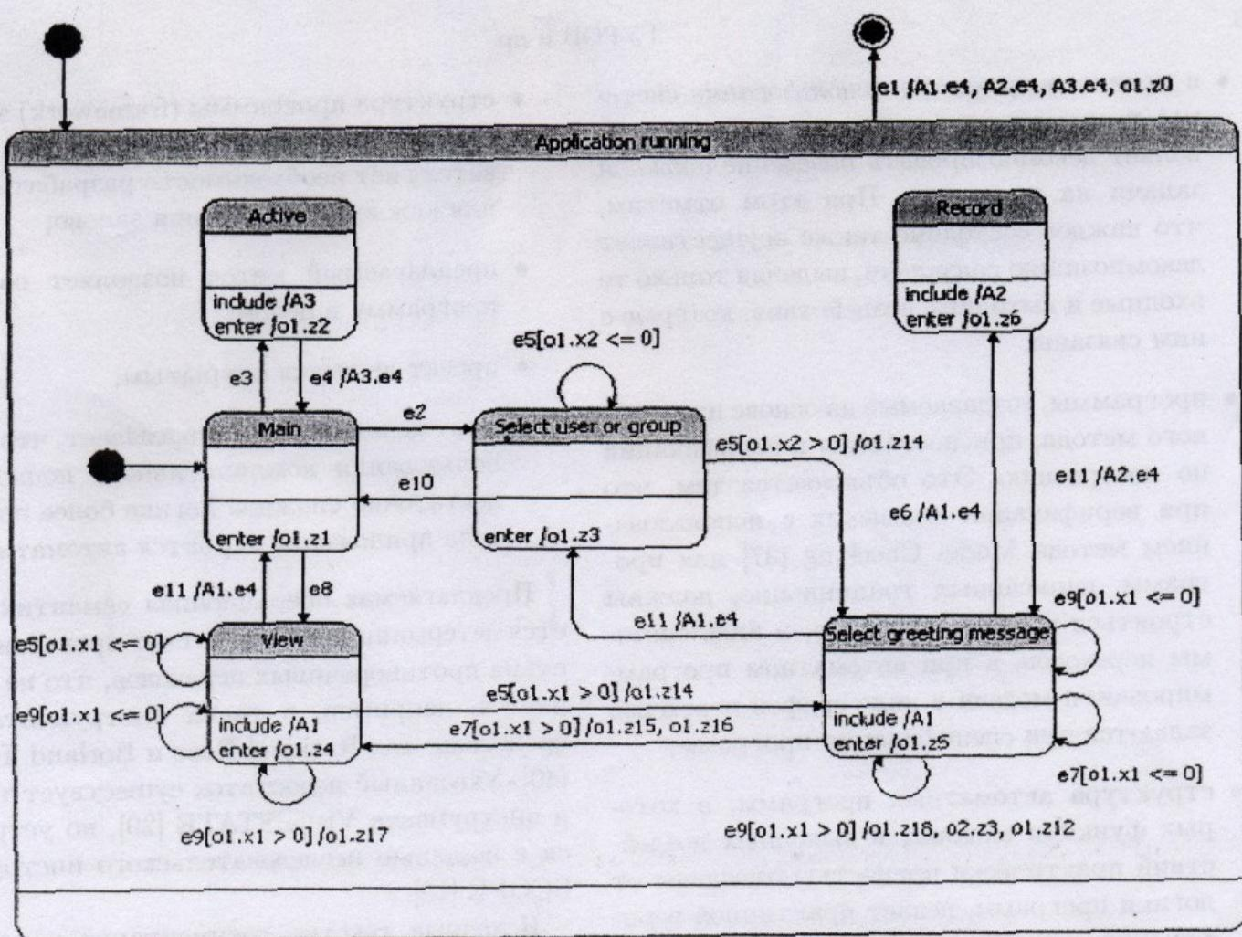
Рис. 9. Диаграмма состояний автоответчика мобильного телефона.
