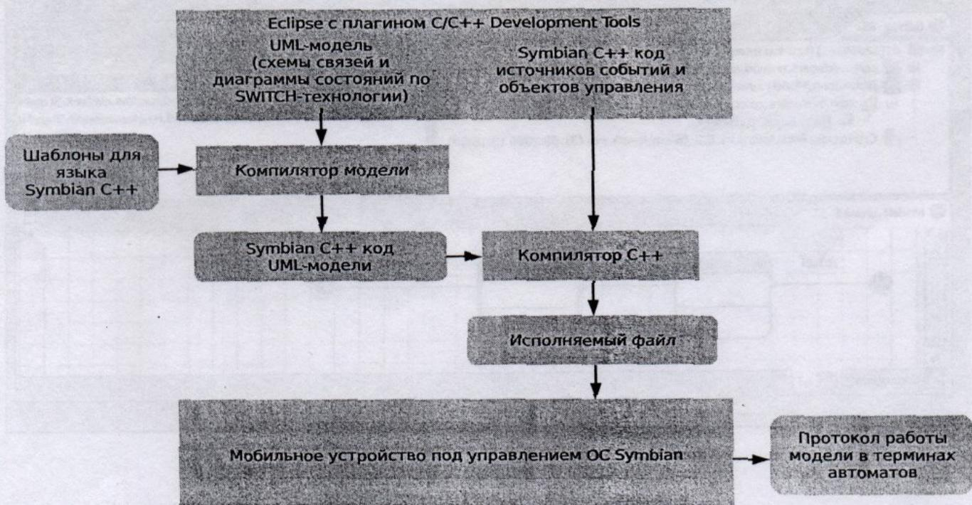
**Рис. 8. Структурная схема компилятивного подхода при использовании Symbian C++.**
