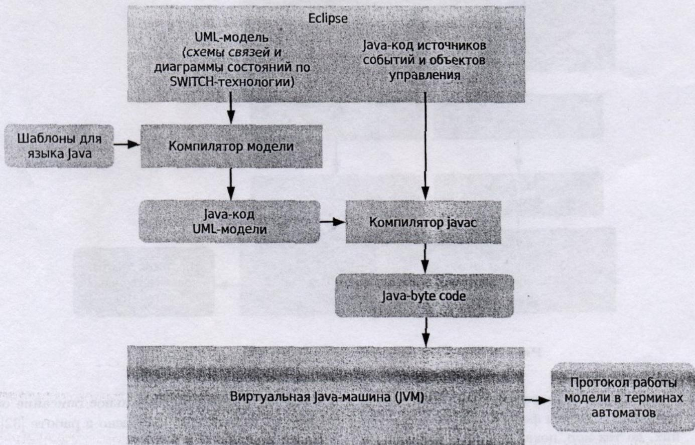
Рис. 4. Структурная схема компилятивного подхода.
