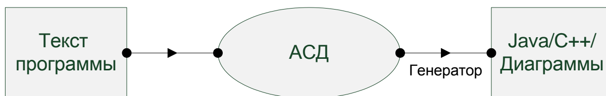
Рис. 3. Стандартная схема интеграции автоматного языка с объектно-ориентированным кодом
