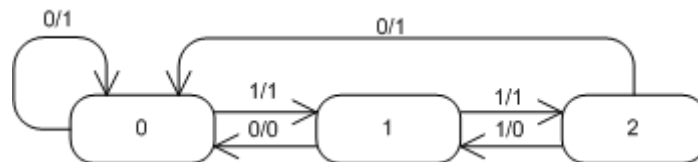
Рис. 10. Граф переходов флиба после удаления неиспользуемых состояний (среда задана битовой маской 11100)
