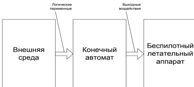
Рис. 1. Структурная схема системы управления беспилотным летательным аппаратом
