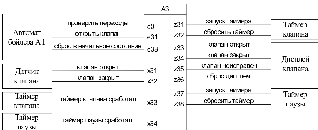
Рис. 6. Схемы связей и графы переходов автоматов управления нагревателем A2 и клапаном A3
