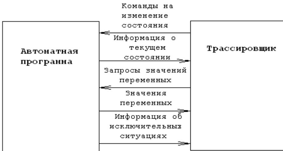
Рис. 2. Схема взаимодействия трассировщика и автоматной программы
