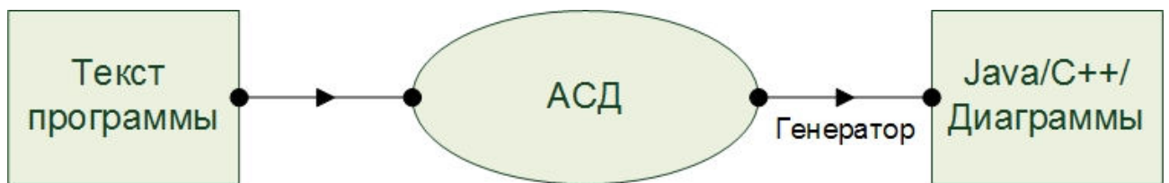
Рис. 1. Стандартная схема интеграции с объектно-ориентированным кодом
