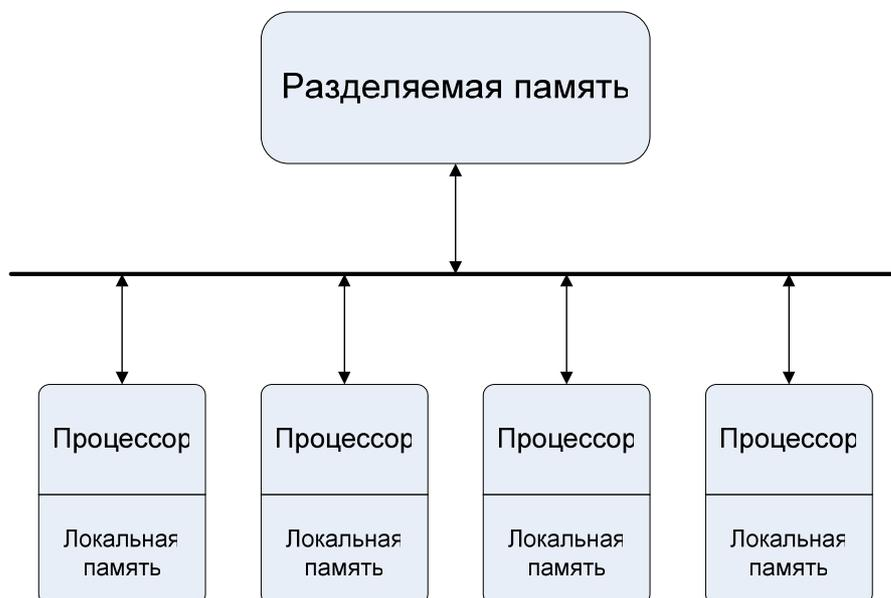
Рис. 1.5. Схематическое изображение многопроцессорной системы
