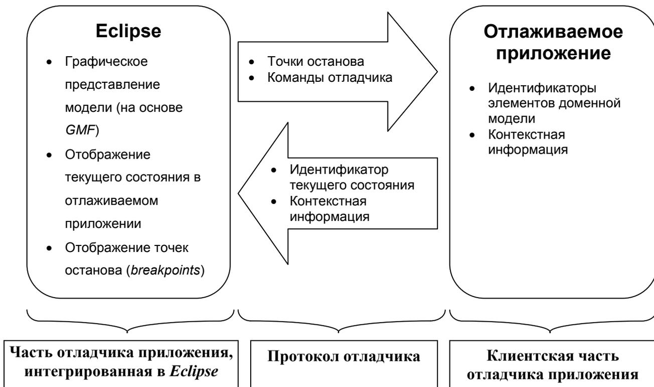
**Рис. 7. Схема компонентов отладчика**
