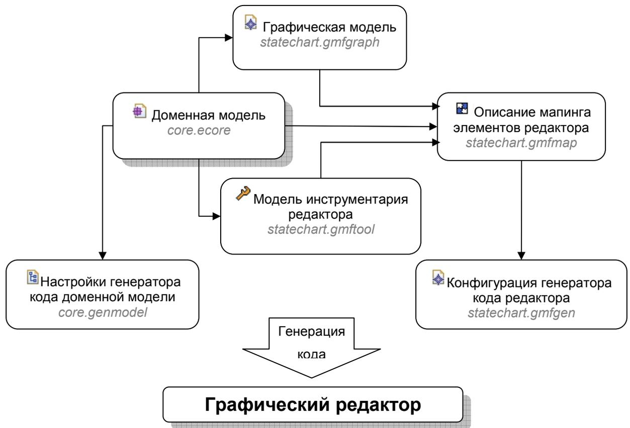
**Рис. 2.** Процесс генерации кода редактора по доменной модели при помощи *GMF*
