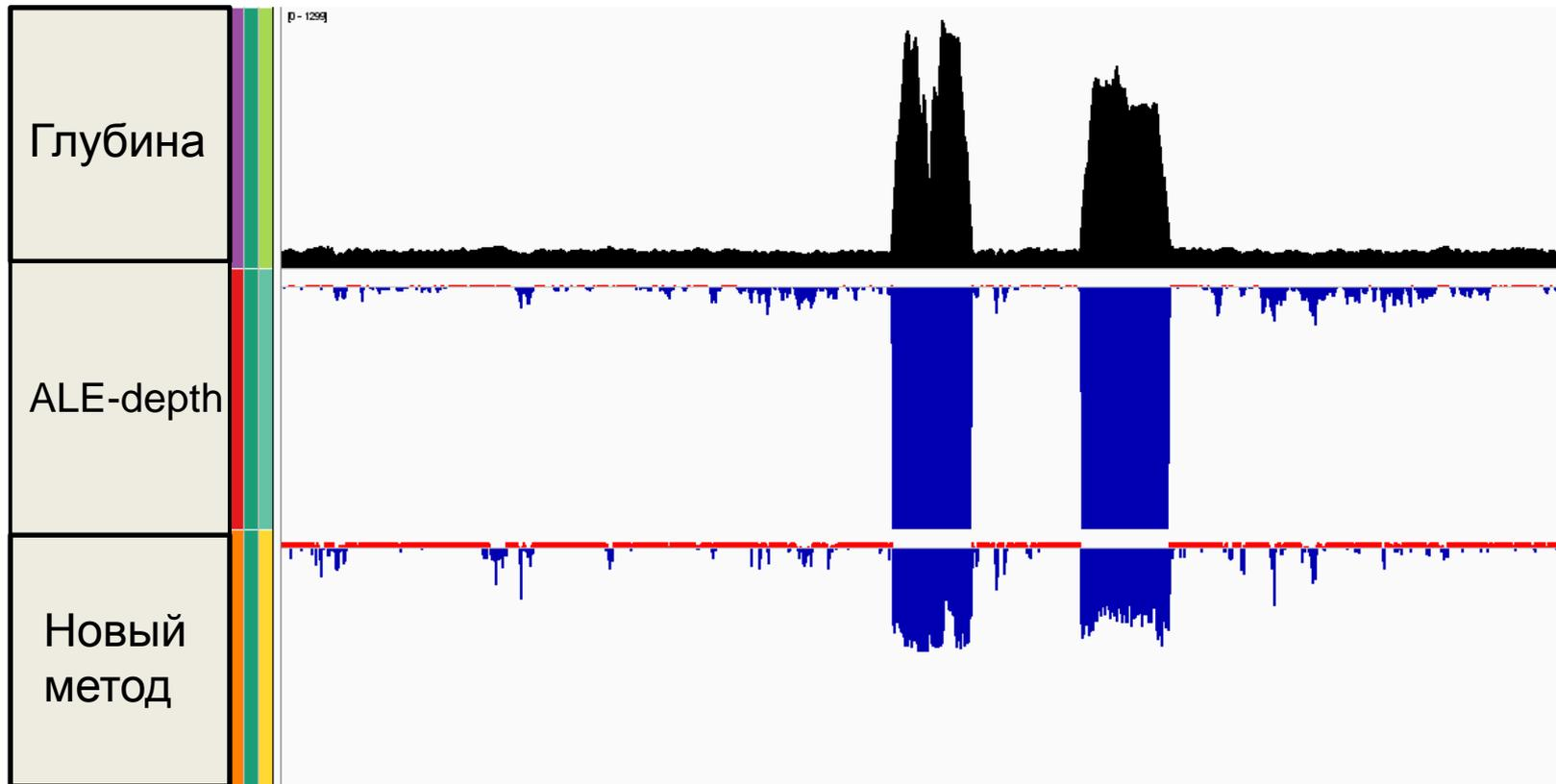
Сравнение работы предложенного метода и ALE при условии резкого возрастания глубины, обусловленного особенностями секвенирования, при помощи IGV.
