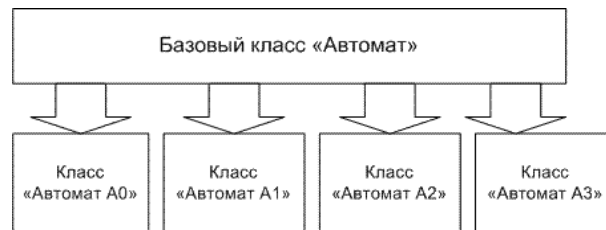
Рис. 5. Фрагмент схемы наследования для классов, реализующих автоматы
