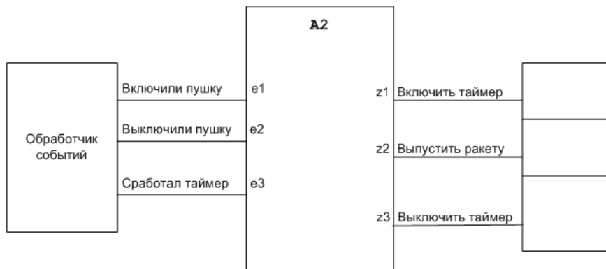
Рис. 14. Схема связей автомата “Пушка” (A2)
