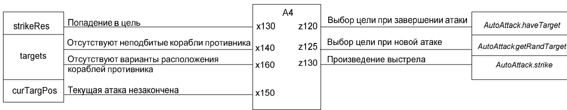
Рис. 16. Схема связей автомата Очередной ход Робота А4
