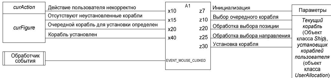
Рис. 7. Схема связей автомата Расстановка кораблей Пользователя A1
