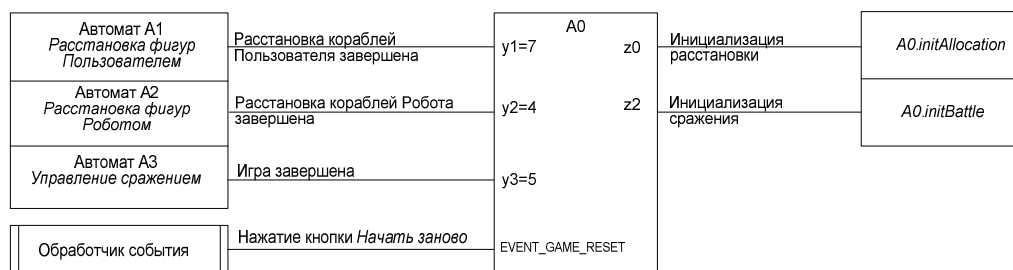
Схема связей главного автомата A0
