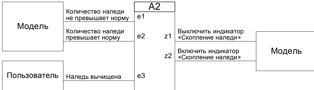
Рис.12. Схема связей автомата «Датчик наледи»
