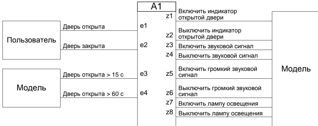
Рис.10. Схема связей автомата «Система слежения за открытыми дверями»
