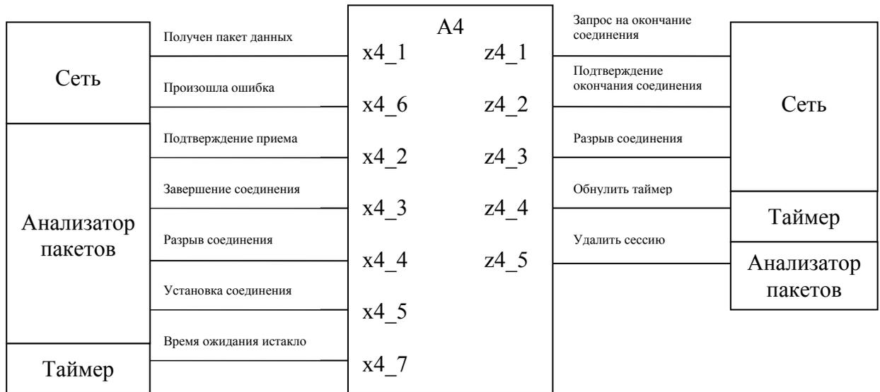
Рис. 15. Схема связей автомата *A4*
