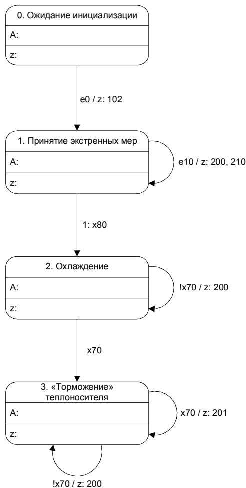
Рис. 15. Граф переходов автомата А5
