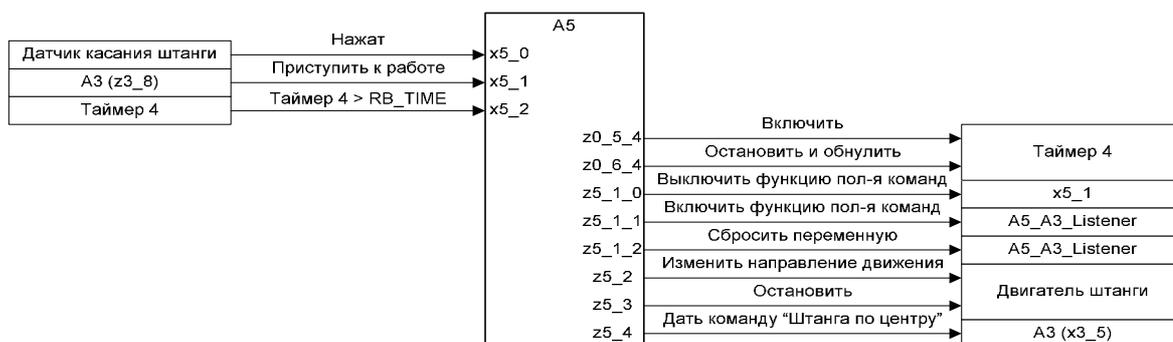
Рис. 16. Схема связей автомата А5. Транспортный робот. Центрирование штанги
