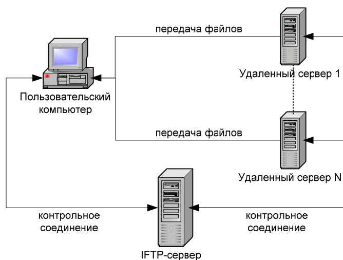
Рис. 2. Модель IFTP -сервера. Передача файлов идет напрямую от удаленного сервера к конечному пользователю, минуя IFTP -сервер
