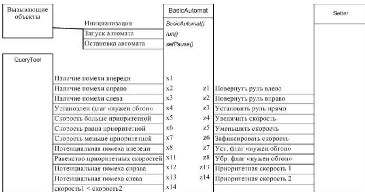
Рис. 4. Структурная схема класса BasicAutomat
