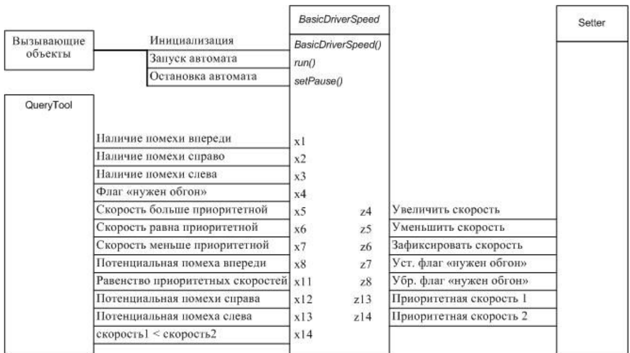
Рис. 5. Структурная схема класса BasicDriverSpeed
