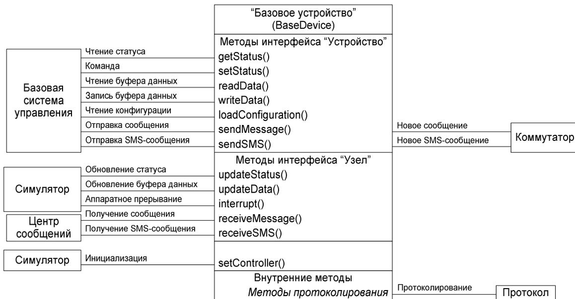
Рис. 28. Структурная схема интерфейса "Базовое устройство"
