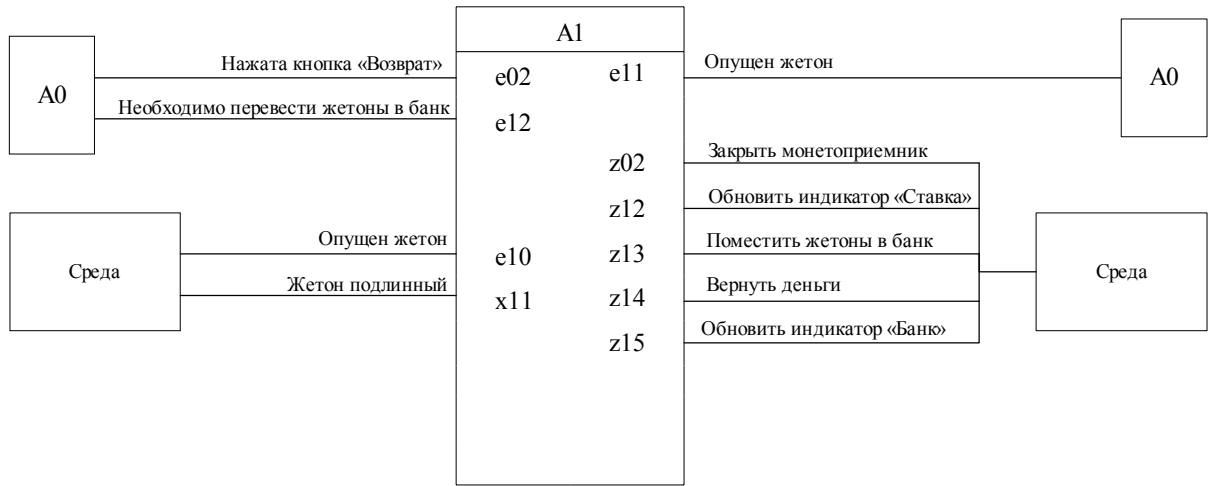
Рис. 5. Схема связей автомата «Монетоприемник» (A1)
